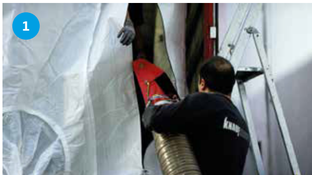
1. Granulki surowca docierają do fabryki ciężarówkami, skąd są zasysane próżniowo do silosów magazynowych.
