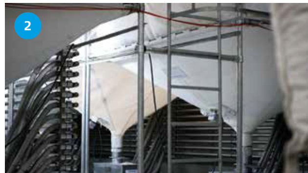
2. Granulki surowca są zasysane z silosu do zbiorników ciśnieniowych znajdujących się przy maszynie/prasie do formowania EPP.
