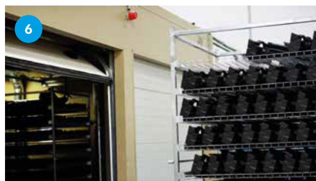
6. Części z przedziału o niskiej gęstości do 60g/l muszą zostać ustabilizowane w piecach z gorącym powietrzem, aby osiągnąć pożądany kształt.
